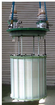
短絡、低損失、大電流等の検証 (短絡400kVA)
