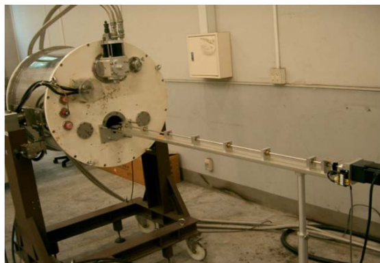
磁場配向モード (超マグ+回転機構)
